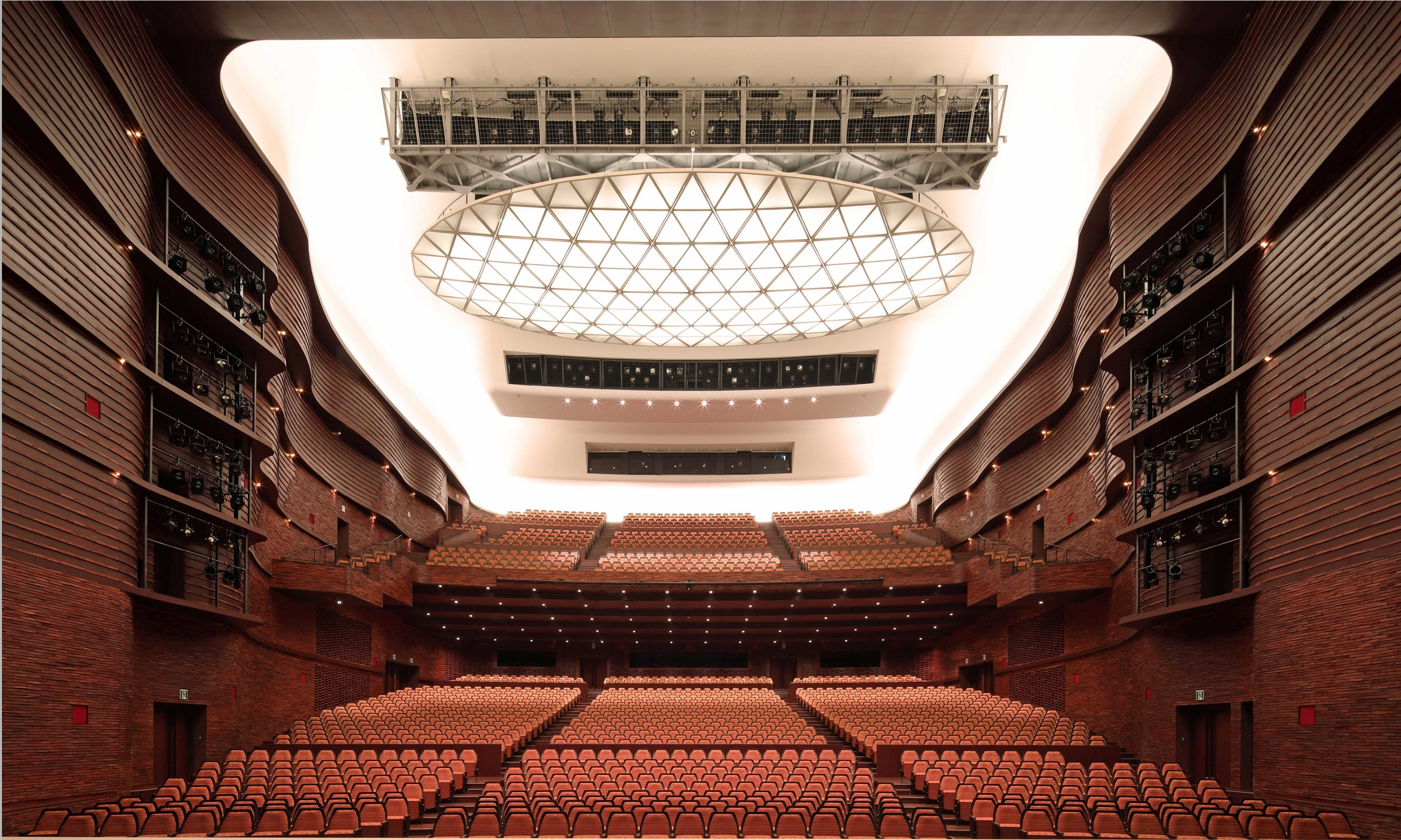
〔大ホール：高機能型ホール(2,007席)〕 壁面の秋田杉の木レンガの凹凸により、豊かな響きが生み出される。
